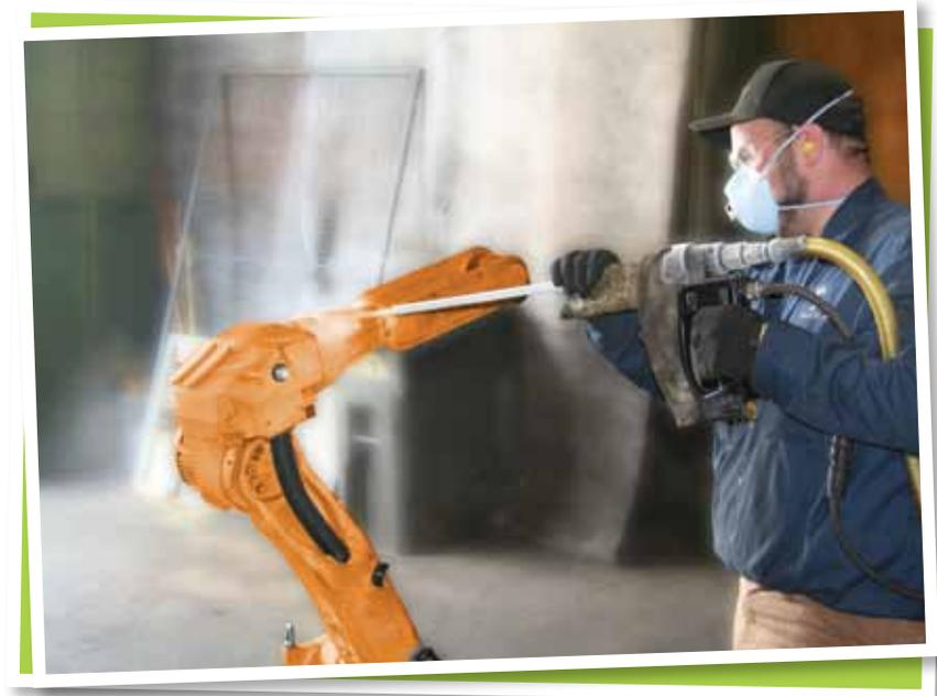
Oberfläche und dem Rückstand. Das CO<sub>2</sub> sublimiert beim Aufprall auf der Roboter Oberfläche und hinterläßt keinen Sekundärabfall.
