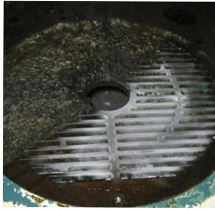
*Cold Jet Trockeneisreinigung wurde verwendet um die Oberflächenverschmutzung auf einem Motor bei einem Automobilhersteller in Michigan zu entfernen. Nach der Umsetzung der regelmäßigen Reinigung mit Trockeneis, konnte die Firma sofort 42 % Energieeinsparungen verbuchen.*
