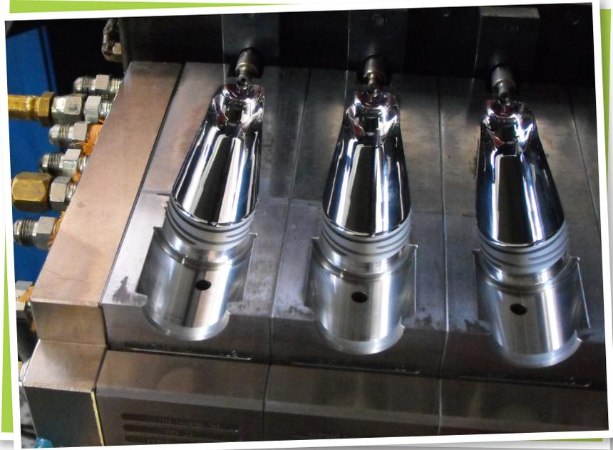
Die Reinigungszeit für eine Form konnte von 2-3 Stunden auf weniger als 45 Minuten reduziert werden. Das Unternehmen findet inzwischen noch andere Anwendungen für das Trockeneisstrahlen wie zum Beispiel das Förderband der Salat Dressing Flaschen.
